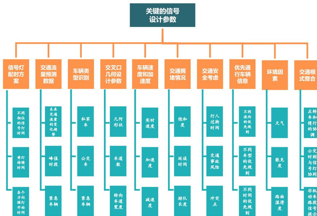
图 8 基于无人驾驶车辆通信的交叉口信号设计关键变量参数
